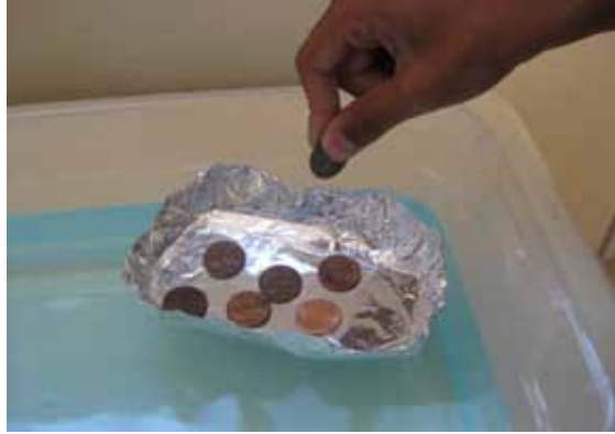
يقوم المشاركون بوضع البنسات في قواربهم واحدًا تلو الآخر. مع التأكد من توزيع الوزن بالتساوي. المصدر: 4 Maria Kapadia/Science Superheroes.
